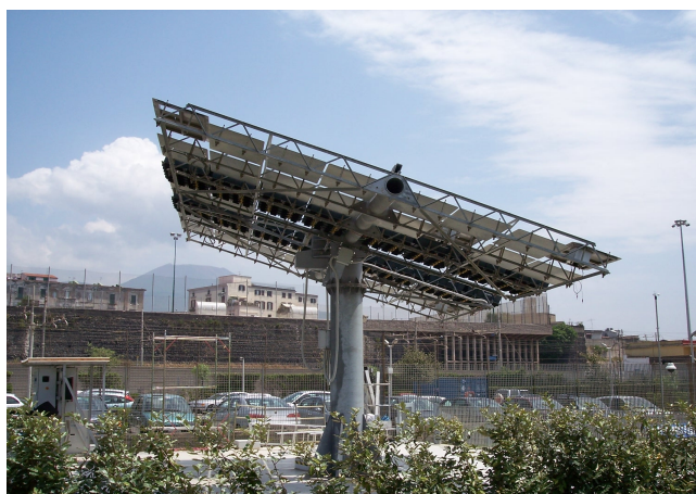
Tracker ATR da 50mq installato al sito ENEA di Portici
