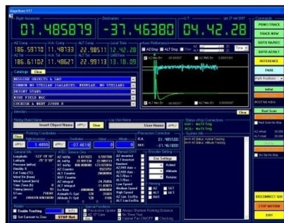
L'interfaccia grafica remota del sistema di controllo.
